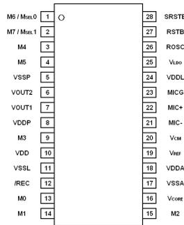
Fig2.Pin out Of IC aPR33A3
