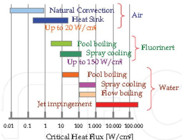
Fig. No. 3- Maximal values of the Critical Heat Flow (Pautsch)
